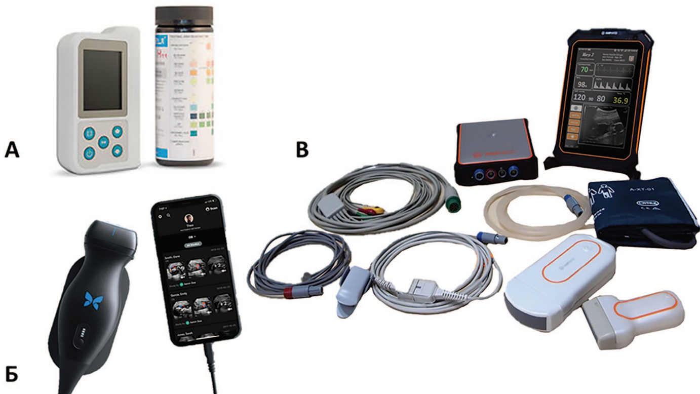
Рис. 2. Портативные медицинские аппараты. А – портативный мочевой анализатор, Б – портативный аппарат ультразвуковой диагностики, В – портативный медицинский трикордер. Fig. 2. Portable medical devices. A – portable urinary analyzer, B – portable ultrasound diagnostic apparatus, C – portable medical tricorder
