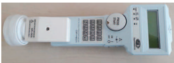
Рис. 2. Прибор для оценки продольной жесткости Digital Inflection Regidometr (DIR-H501, Uroan 21, Electromedicina, Испания).
