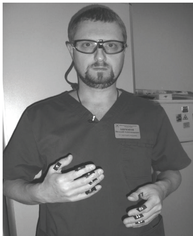
Рис. 4. Размещение сборок дозиметров для измерений локальных доз облучения пальцев и глаз оператора Fig. 4. Placement of assemblies of dosimeters for measuring local doses of radiation to the fingers and eyes of the operator
