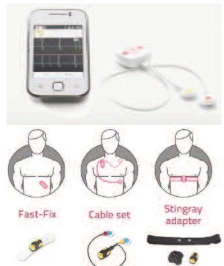
Рис. 3. Носимые мониторы сердечной деятельности. Варианты расположения на теле
