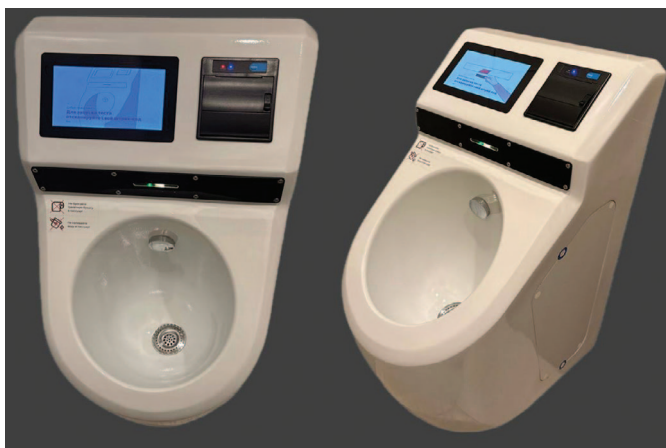
Рис. 1. Автономный урофлоуметр мужской Fig. 1. Autonomous uroflowmeter for men
